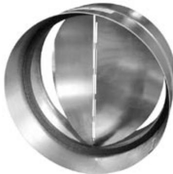
Обратные клапаны RSK предназначены для автоматического перекрывания круглых воздуховодов при выключении вентилятора. Корпус клапана выполнен из оцинкованной стали, лопасти изготовлены из листового алюминия. Конструкция корпуса клапана позволяет крепить его к воздуховодам или другим элементам системы вентиляции с помощью хомутов. Клапан может быть установлен в любом положении, обеспечивающем при закрытии клапана плотное прилегание лопастей к корпусу.
